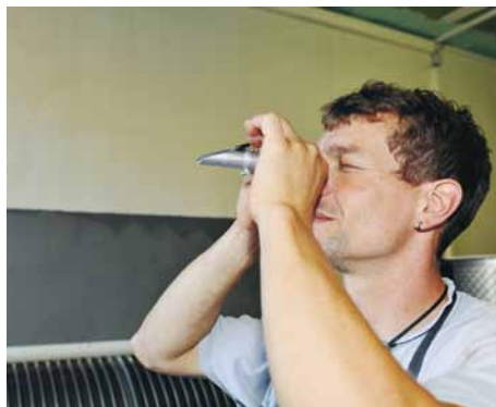
Mit dem Refraktor wird der Zuckergehalt des Traubenmostes gemessen.
